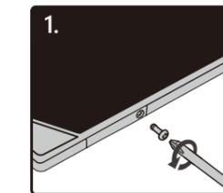
プラスドライバーで電池蓋のネジをはずします。
