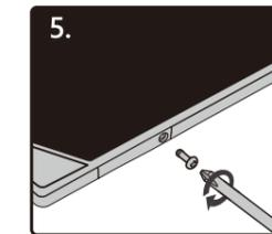
プラスドライバーでネジを締めます。
