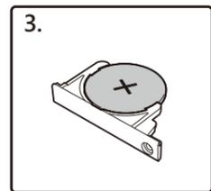
コイン形リチウム電池(CR2016)を交換します。
